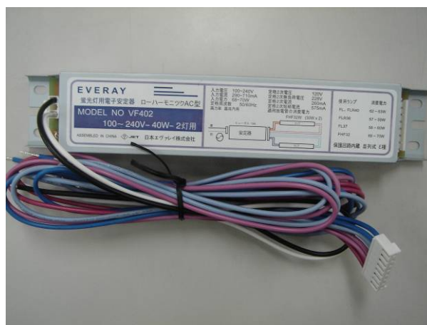
日本エヴァレイ株式会社 電子安定器 ローハーモニック AC 型 MODEL NO VF402 100~240V-40W-2 灯用
